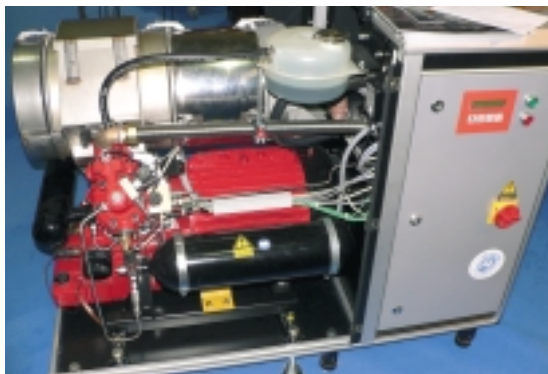
Prototyp malé plynové kogenerační jednotky se Stirlingovým motorem.
