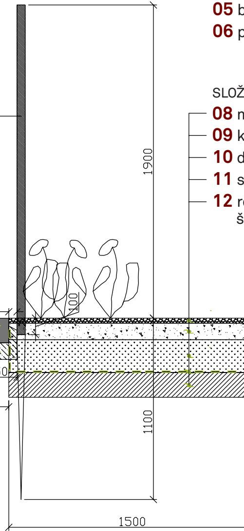
**05** betonová mazanina, beton B 10**06** předpokládané vedení inženýrských sítí
