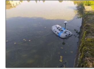
Foto 5 – Aparatura pro stanovení hloubek v rybníku – River Surveyor M9.
