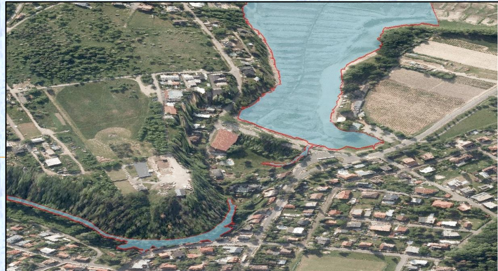
Animace průchodu povodňových průtoků přes hráz rybníka.
