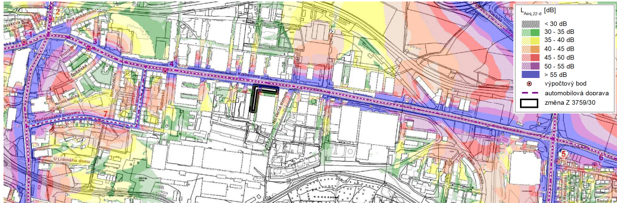
Obr. 10. L_{Aeq} [22 až 6 hod], stav po změně, izofony ve výšce 4 m nad terénem
